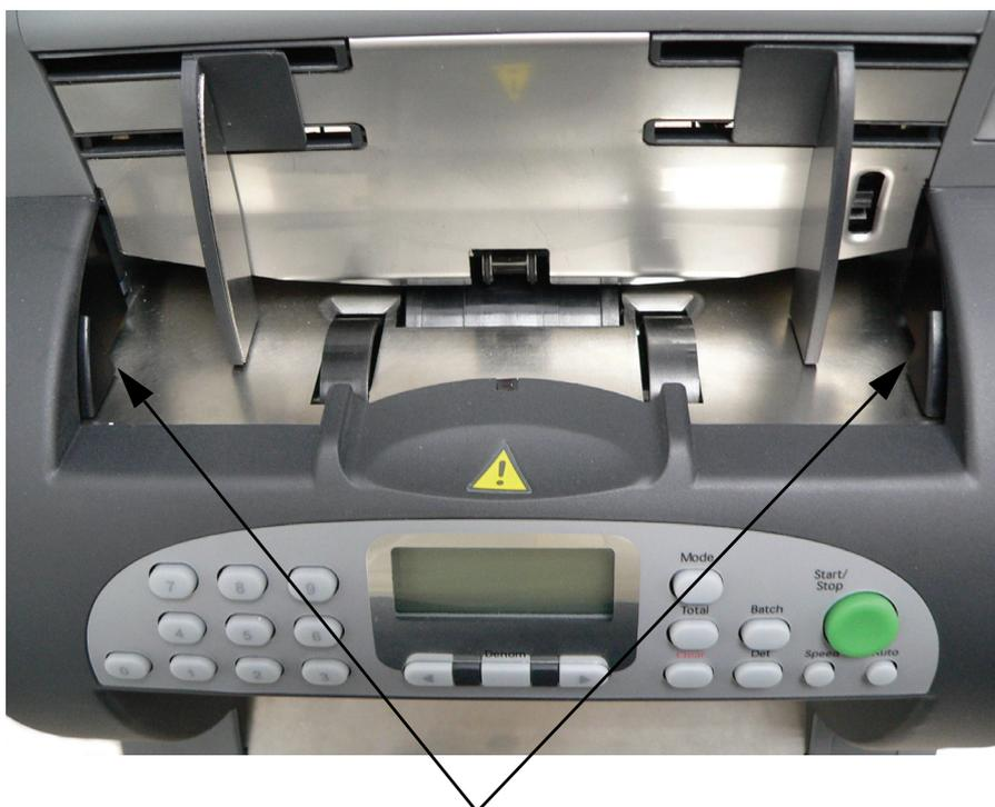
Кнопки открывания блока датчиков / доступа к каналу подачи банкнот
