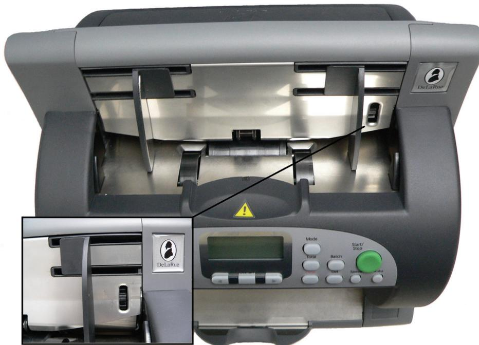
Регулировка зазора в механизме подачи может быть необходима с деньгами различного состояния:
