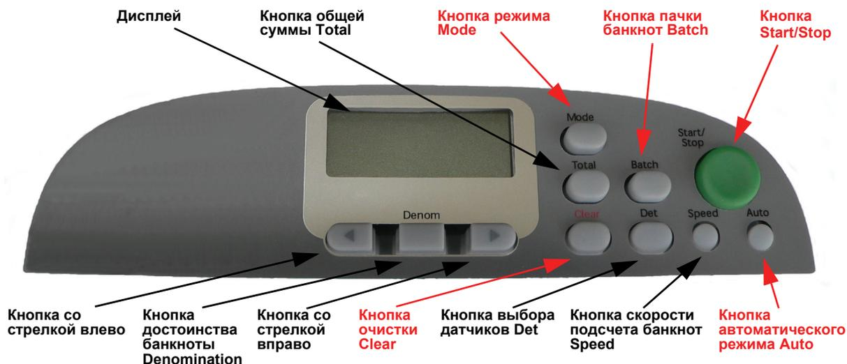
Счетчик EV8626 находится в режиме счета количества банкнот, если на дисплее не отображается линия или режим фасовки. Счетчик будет вести счет банкнот непрерывно, останавливаясь только при заполнении накопителя.
